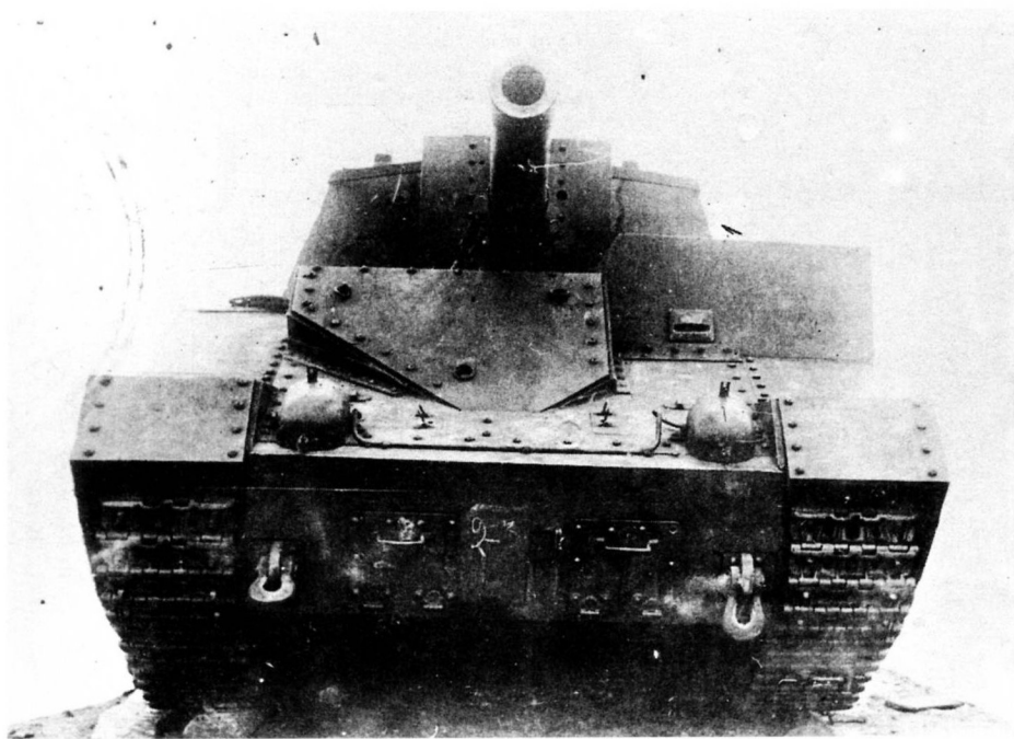
СУ-14-1 с дополнительной бронировкой (эталонный образец с пушкой Бр-2) на НИБТПолигоне осенью 1940 года.
